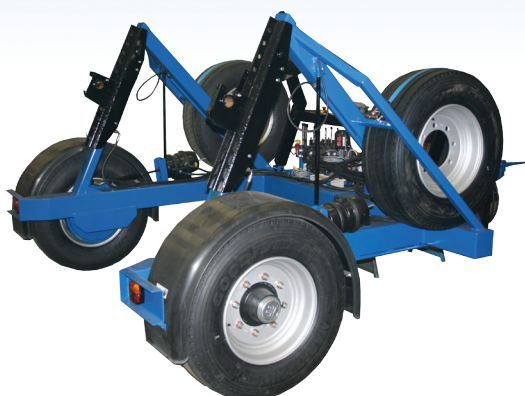
Kabeltrumvagn 10 ton justerbar.
