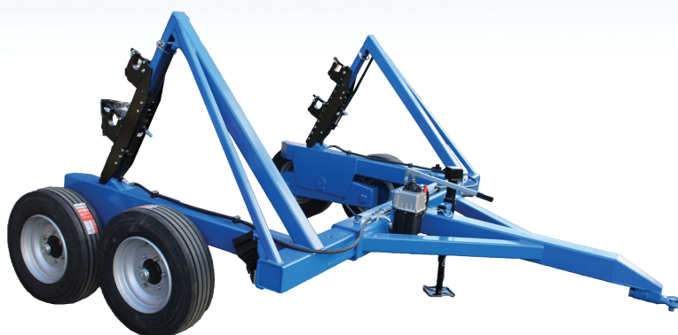
Kabeltrumvagn med drift och luftbromsar
