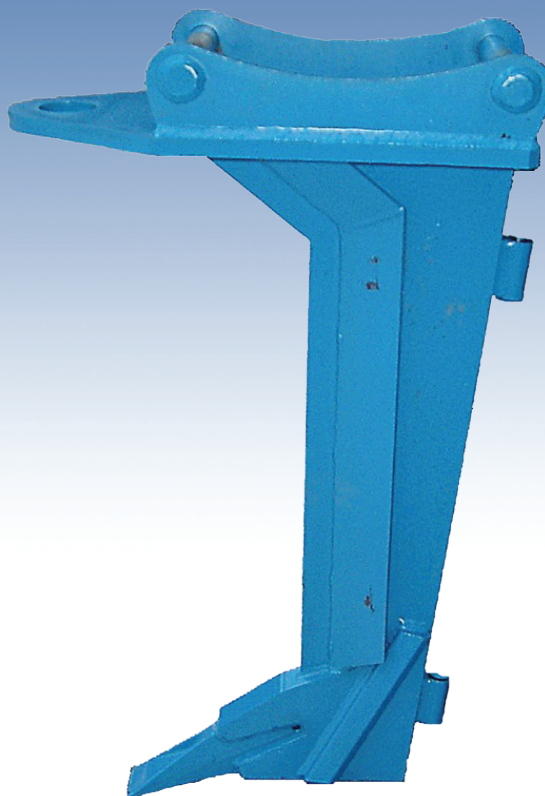
Plogkropp - kan användas separat som förrivare.
